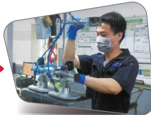
增設吸晶柱省力裝置，降低人員搬運過程之負荷及受傷之風險
