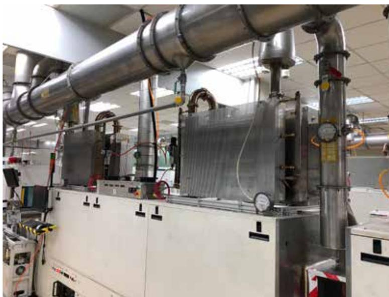
▲ 網印設備出口端增設燃燒器，降低 VOCs 排放量
