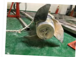
改善前-攪拌機扇葉嚴重磨損
