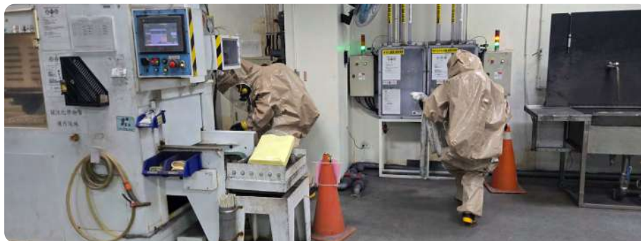
4. 搶救班進入熱區：(1) 操作機台 - 停止排酸 (止洩)、(2) 於洩漏處鋪設吸液棉 (索)、(3) 洩漏處無殘液後，將吸液棉 (索) 放入有害廢棄物處理袋
