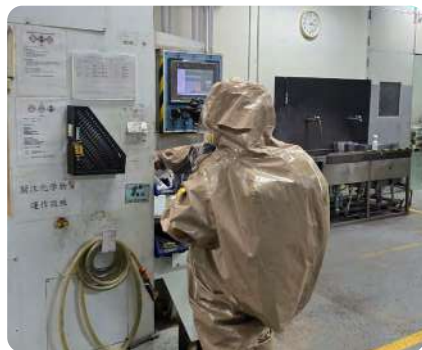
4. 搶救班進入熱區：(1) 操作機台 - 停止排酸 (止洩)、(2) 於洩漏處鋪設吸液棉 (索)、(3) 洩漏處無殘液後，將吸液棉 (索) 放入有害廢棄物處理袋
